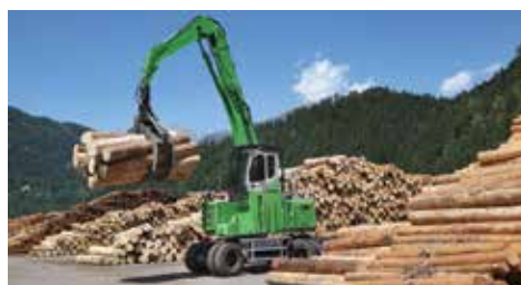
A extensão articulada permite otimizar a distribuição do peso durante o transporte
