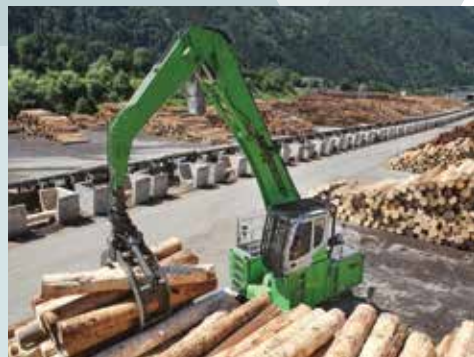
A cabina rotativa, com visibilidade a 360°, permite uma manipulação simples entre linhas de empilhamento
